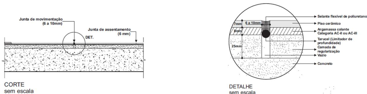
A selagem das juntas de movimentação e de dessolidarização deve ser executada, após assentamento do piso cerâmico, limpando as juntas com cinzel e aplicando ar comprimido para retirada do pó. Proteger as bordas das placas cerâmicas com fita “crepe”.
